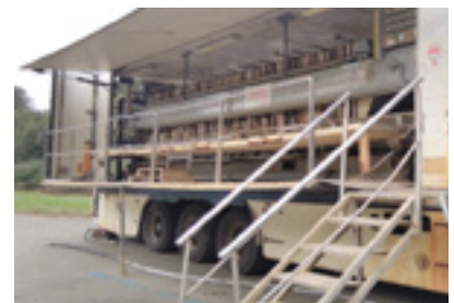
Presse Mobile à Lanvollon pour déshydratation des boues des STEP de Lanvollon et Pommerit-le-Vicomte.
