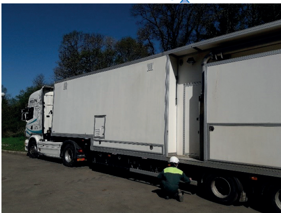
Unité mobile de déshydratation des boues à la step de Lanvollon pendant le 1 er confinement, pour déshydratation pour envoi en compostage.
